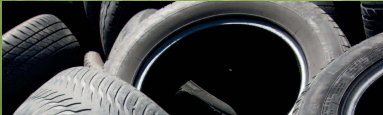
*Mit SBR-Gummi bezeichnet man Gummi aus Altreifen. Für die Herstellung von Reifen werden nur die besten Rohstoffe verwendet. Nach einem hochwertigen Recyclingverfahren erhält dieser Gummi noch einen zweiten Lebenszyklus als Einstreugranulat für Kunstrasensysteme.*
