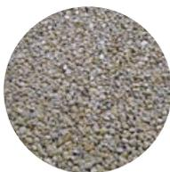
Die obersten beiden Lagen des Sandplatzes (Ziegelmehlschicht und Schlackeschicht) werden entfernt und durch ein PU-gebundenes Splittgemisch ersetzt.
